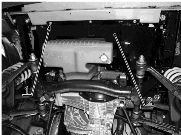
Рис.7 Снятие ремня привода навесных агрегатов:
