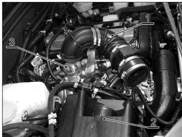
Отверните болт и два самонарезающих винта крепления воздухозаборника 1, рис.5, к кузову, отсоедините от воздушного фильтра и снимите воздухозаборник.
