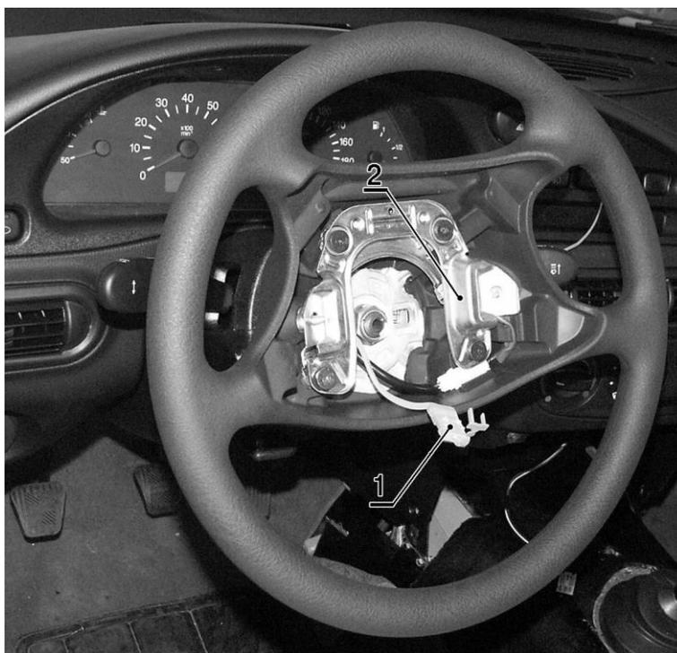
Рис.5 Рулевое колесо системы надувной подушки:
