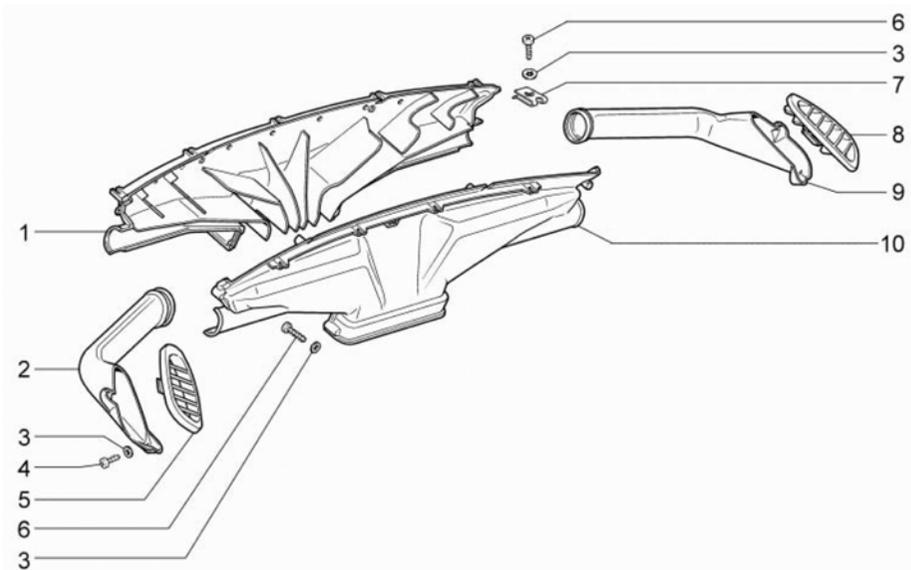
**8120 КОРПУС РАСПРЕДЕЛИТЕЛЯ И ВОЗДУХОВОД (ПРОДОЛЖАЕМАЯ)**
