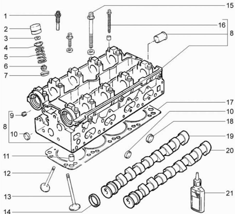
**1310 ГОЛОВКА ЦИЛИНДРОВ, СВЕЧИ ЗАЖИГАНИЯ И ПРОКЛАДКА**
