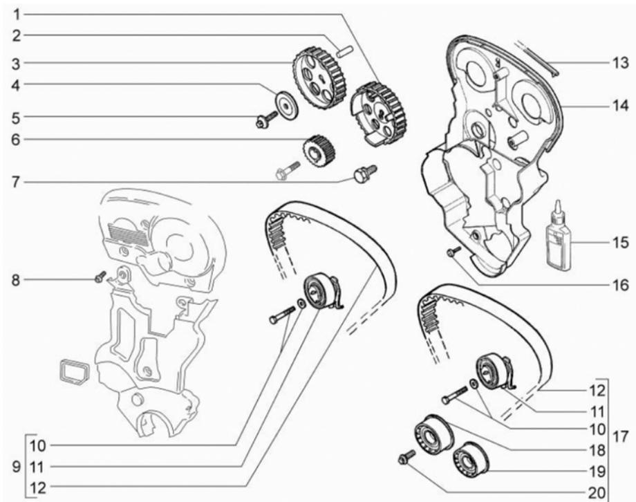
1330 ПРИВОДНОЙ РЕМЕНЬ ГАЗОРАСПРЕДЕЛИТЕЛЬНОГО МЕХАНИЗМА, ПЕРЕДАЧИ И ШКИВЫ
