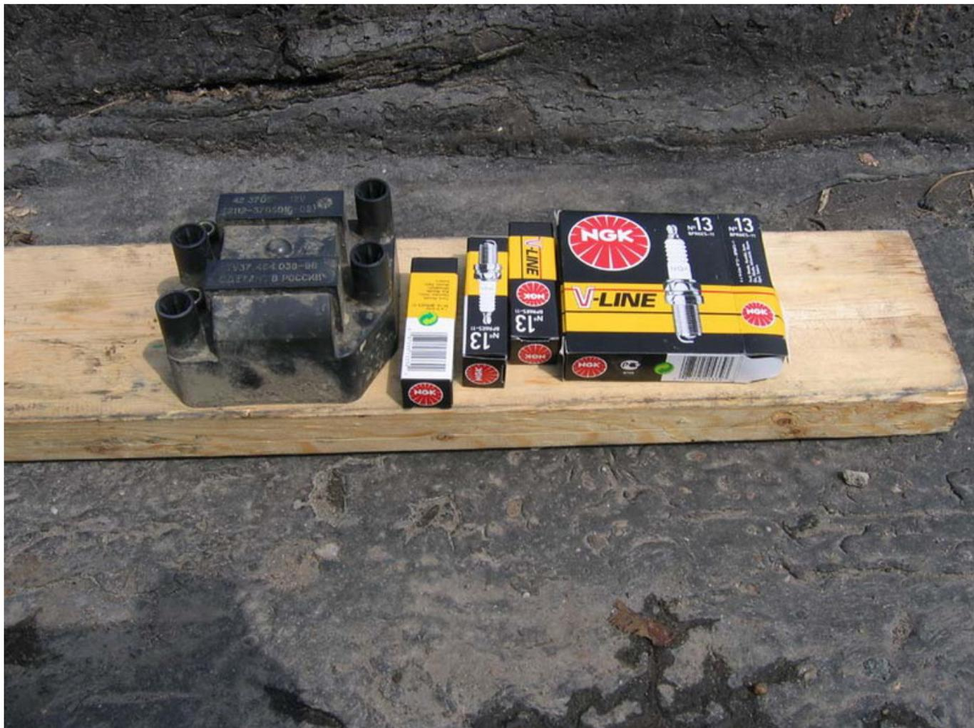
Вобщем пришлось поменять МЗ, свечи и катализатор. В катализаторе от высокой температуры, за короткое время!, блоки сот分离 от корпуса и гремели при езде.
