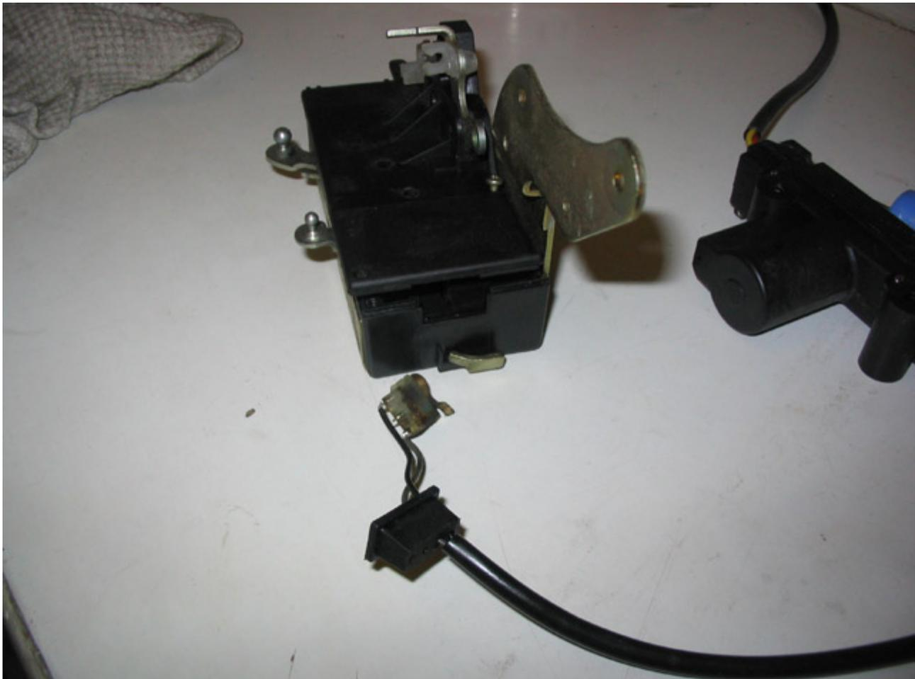
Для снятия концевика необходимо открутить еще три маленьких шурупа на пластиковой крышке замка. А это фото замка без крышки
