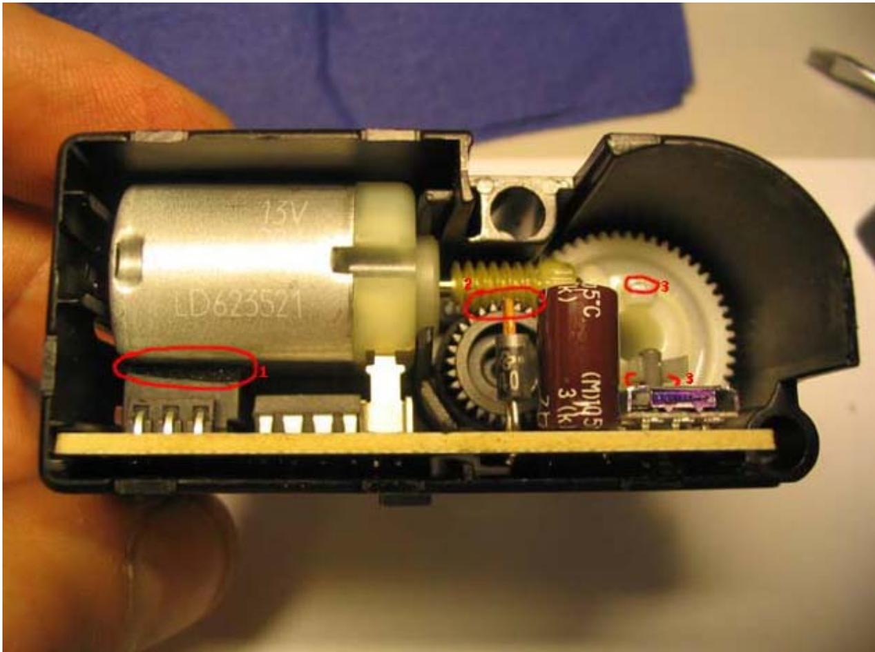
Цифрой 1 обозначено место куда я проложил небольшой кусочек вспененного скоча дабы хоть немного поджать соединение обозначенное цифрой 2 (похоже что именно здесь и происходят «щелчки»). Цифрой 3 обозначено место где сам шток(на нем резьба) «вкручивается в шестеренку» посредством которой он и движется, именно в конце резьбы есть с двух сторон выступы пластмассы за грани этой резьбы их то я аккуратно но и подрезал.
