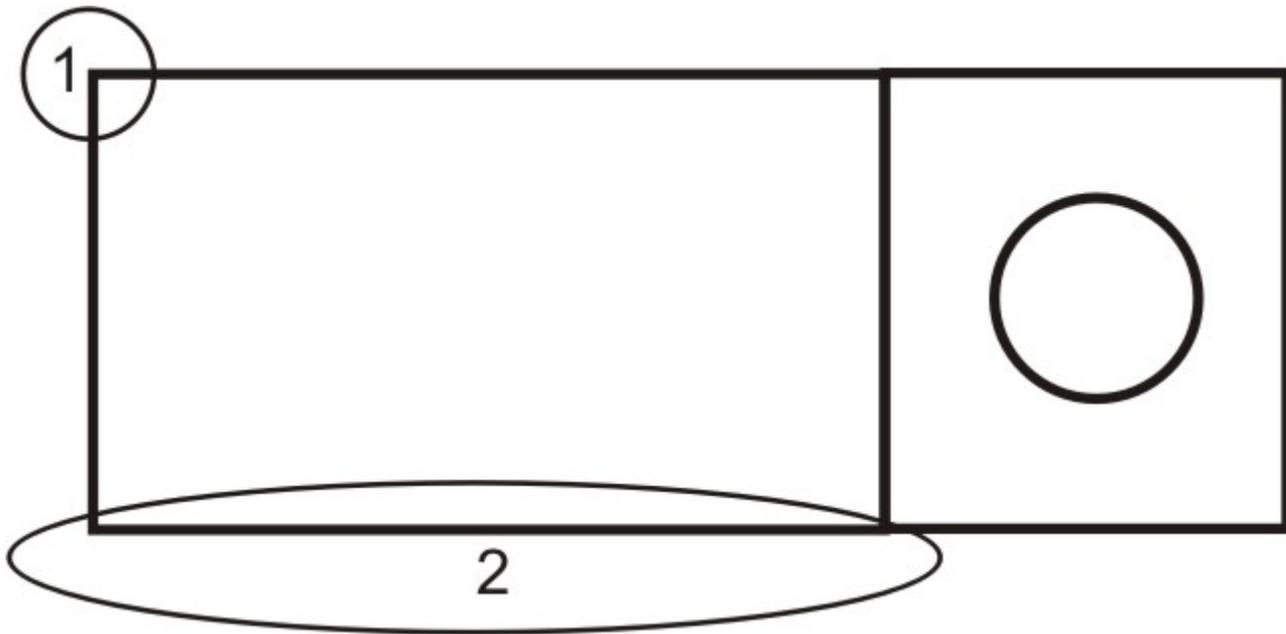
показано где я делал распилы. В области 1 я распилил угол по шву для того, чтобы БК убрался по длине. Стенку 2 я уменьшал по высоте так, чтобы БК был примерно параллельно кронштейну. После этого БК помещается вместо пепельницы.
