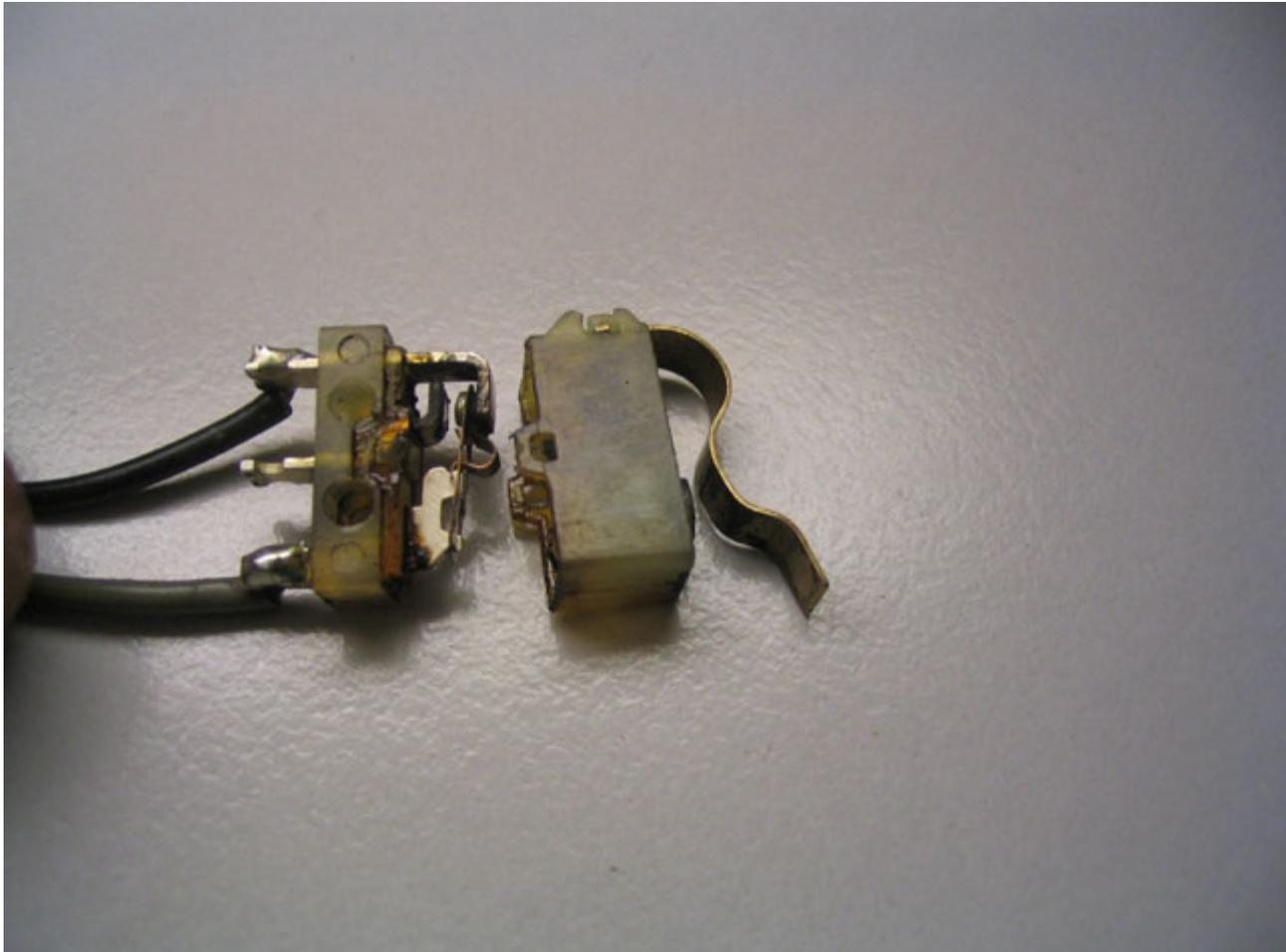
Что было проделано: разобрал корпус концевика прочистил его, промыл спиртом, добавил буквально каплю WD-40 на металлические элементы, и собрал его обратно при этом проклеив влагостойким клеем тот самый шов.
