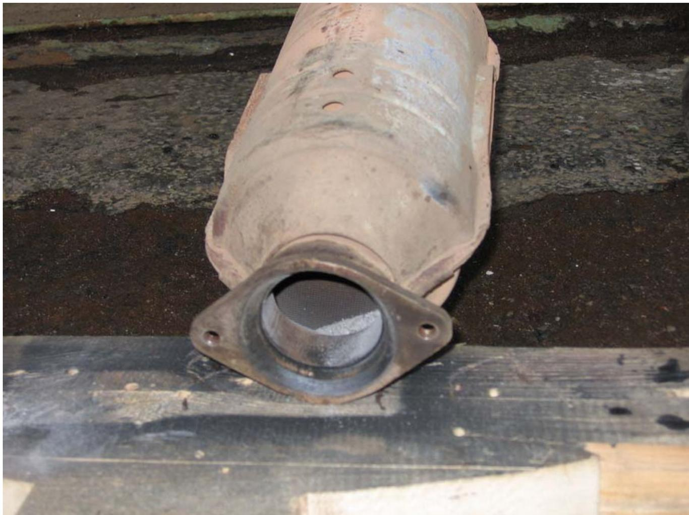
Пробил я его ломом(очистил от сот). Новый стоит дорого, выше 8000р, т.к он сварен вместе с резонатором и трубой до глушителя.
