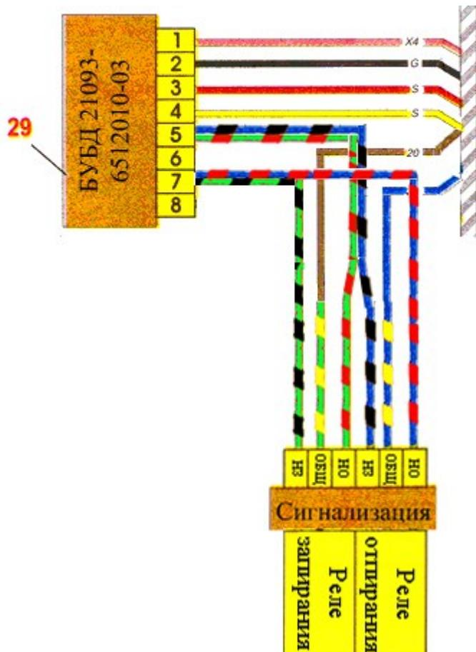
В случае необходимости обратный демонтаж проводки сведётся только к обжиманию новыми клеммами голубого и коричневого проводов.
