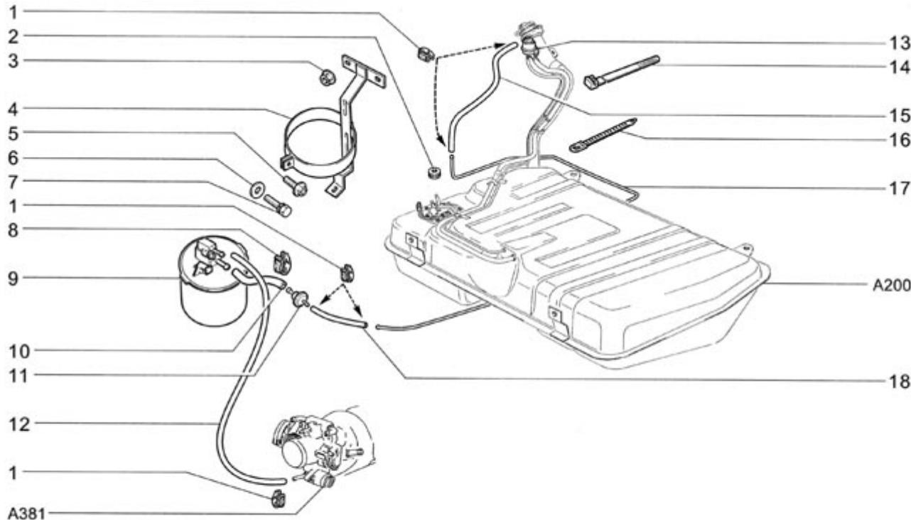
**СИСТЕМА УЛАВЛИВАНИЯ ПАРОВ БЕНЗИНА****A220**
