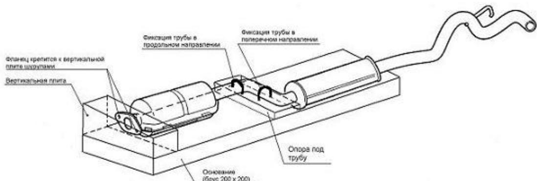
**Рисунок 1 - схема сварочного кондуктора**
