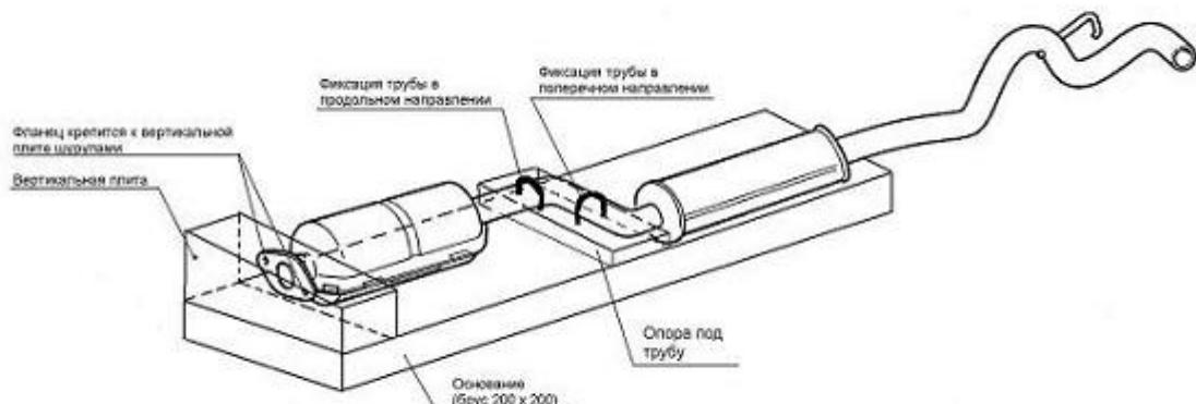
**Рисунок 1 - схема сварочного кондуктора**
