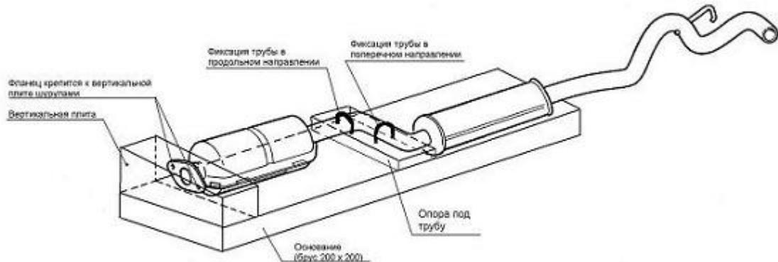
**Рисунок 1 - схема сварочного кондуктора**
