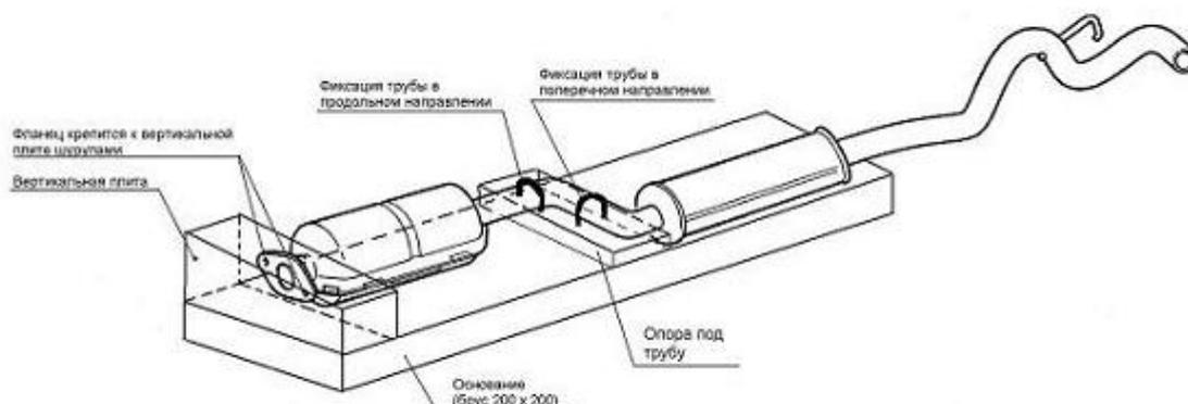
**Рисунок 1 - схема сварочного кондуктора**
