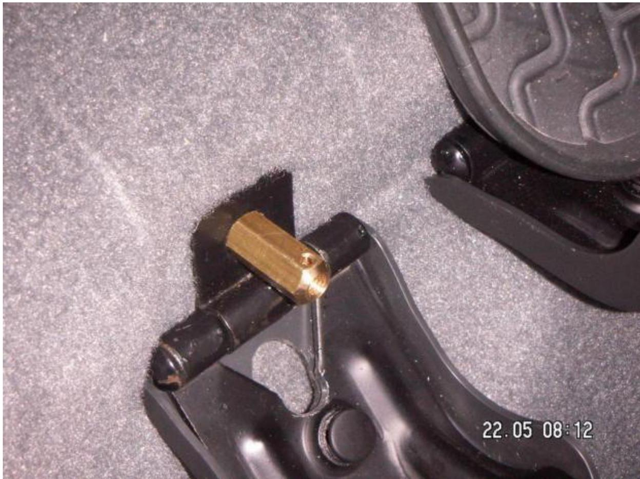
Теперь мы имеем возможность снимать и устанавливать подушку не откидывая ее! Длина гайки подбирается таким образом, чтобы ее можно было отвернуть наружу, но чтобы она не мешала штатному откидыванию привернутой подушки.
