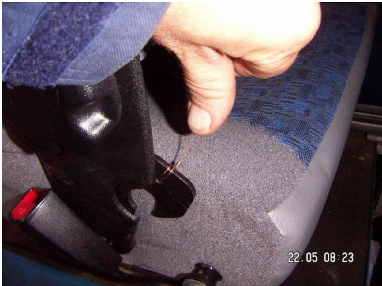
6. Прикладываем накладку кресла и отмечаем место до которого доходит кронштейн спинки.
