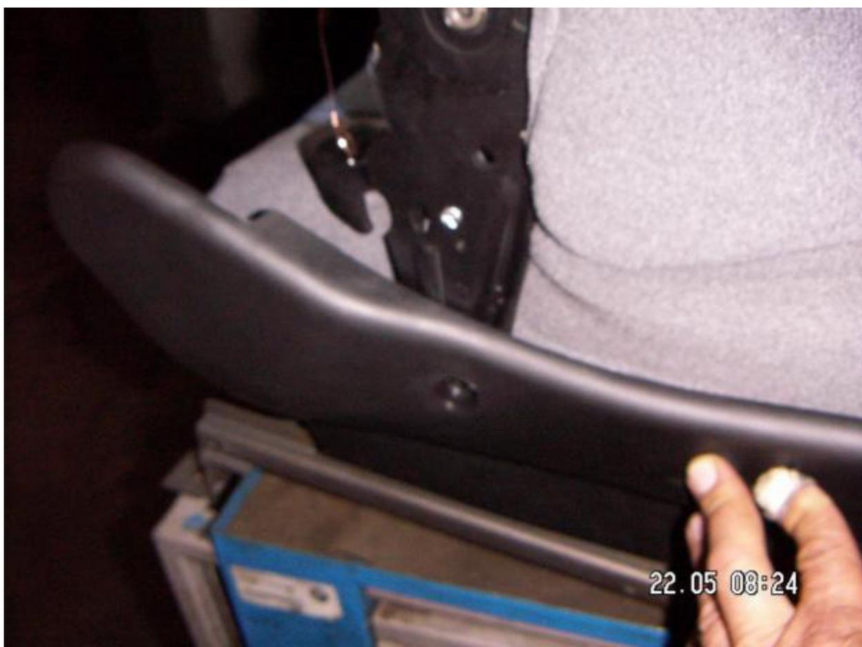
7. Отрезаем кусок накладки для свободного движения кронштейна при складывании.(при этом придется пожертвовать защелкой- она попадает на отрезаемый кусочек)
