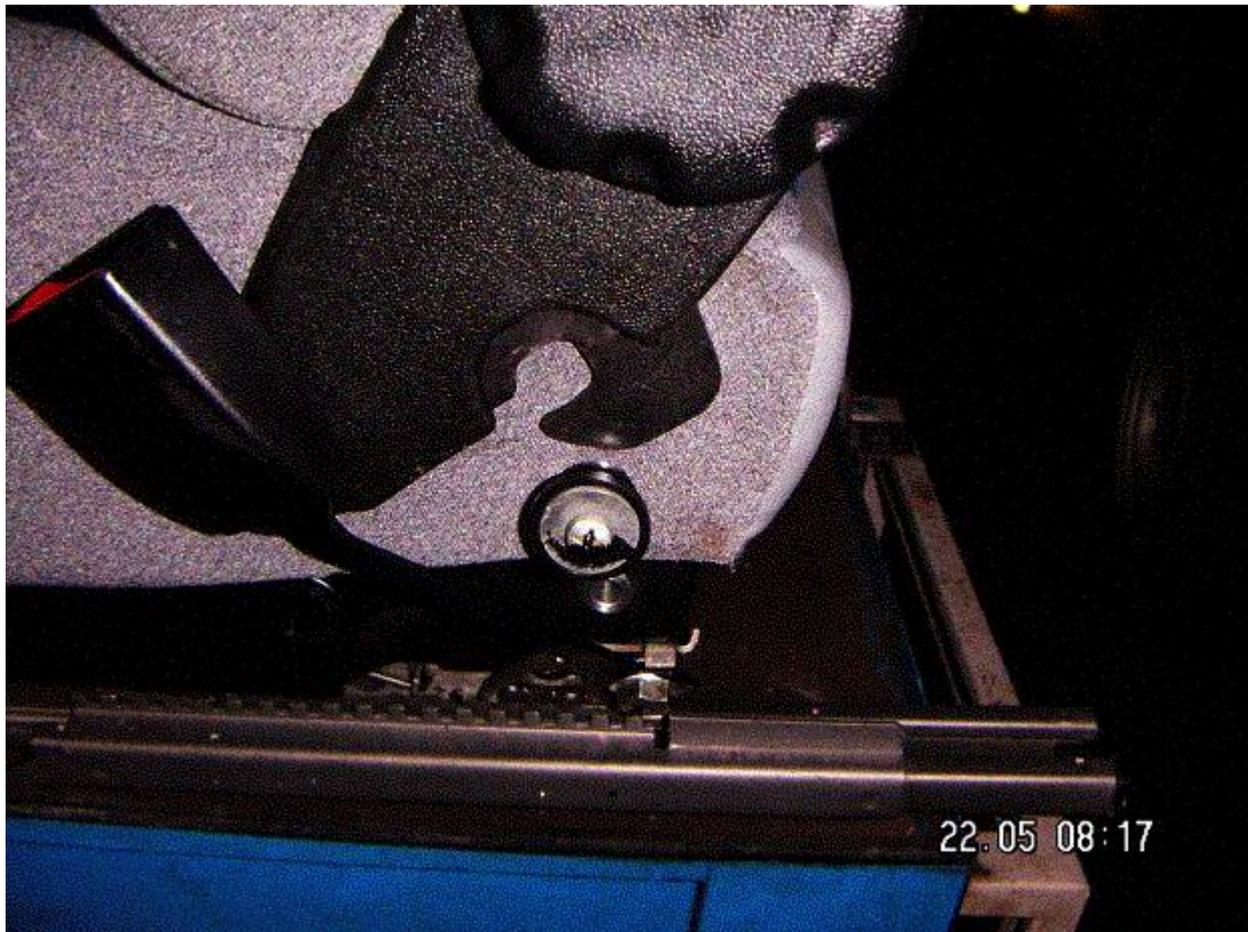
5. Через отверстия имеющиеся на крюках соединяем их тонкой проволокой – выбирая длину петли с тем расчетом чтобы она пряталась за клапан обшивки обивки спинки.
