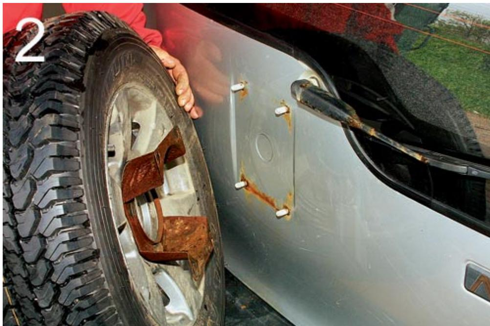
Итак, начнем. Вооружимся дрелью, сверлами и шарошкой. Сняв обивку двери (фото 3), демонтируем моторедуктор стеклоочистителя (фото 4), после чего во внутренней панели напротив шпилек проделаем четыре отверстия (фото 5, стрелки!) такого диаметра, который позволит в дальнейшем затянуть гайки торцевой головкой «на 17». Мы их размер не указываем, ведь ключи бывают разные. Старые шпильки высверливаем, отверстия обрабатываем антикором.
