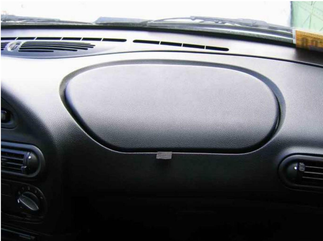
Поначалу я сомневался в бесшумности конструкции, особенно при переезде неровностей на большой скорости. Но, как оказалось, крышка, не имеющая фиксатора, в движении не дребезжит и не открывается. Для бесшумного, «солидного» закрывания крышки, на два крайних пяточка (куда закручивались ранее саморезы) приклеил кругляши пористой резины (от коврика для мыши). В качестве замка можно применить небольшие магнитики.
