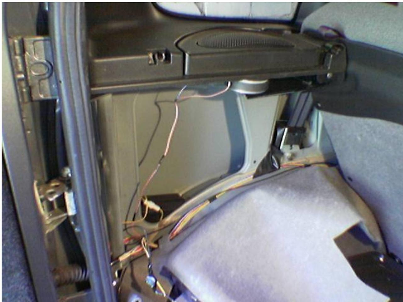
6. Подметил через готовый кронштейн отверстия в кузове. Выполнил отверстия в кузове.
