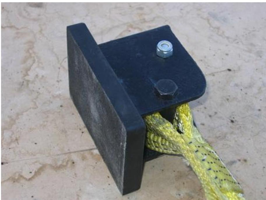
Корпус сварен из листовой стали толщиной 5мм.
