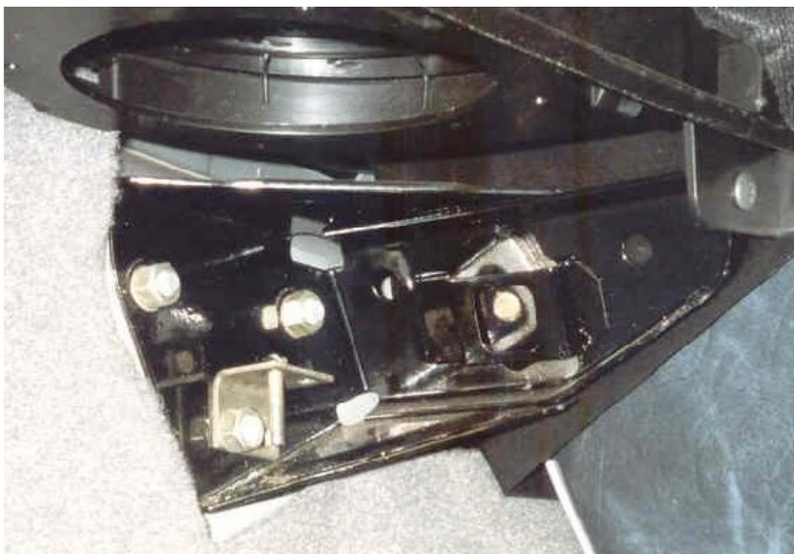
Закручиваю родную гайку назад на шпильку. Вставляю органайзер. Потом просовываю сверху через отверстие в крышке «С» болт диаметром 6 мм и попадаю им как раз в отверстие в уголке, надетом на шпильку крепления спинки. Снизу надеваю на болт шайбу и навинчиваю гайку. Всё.
