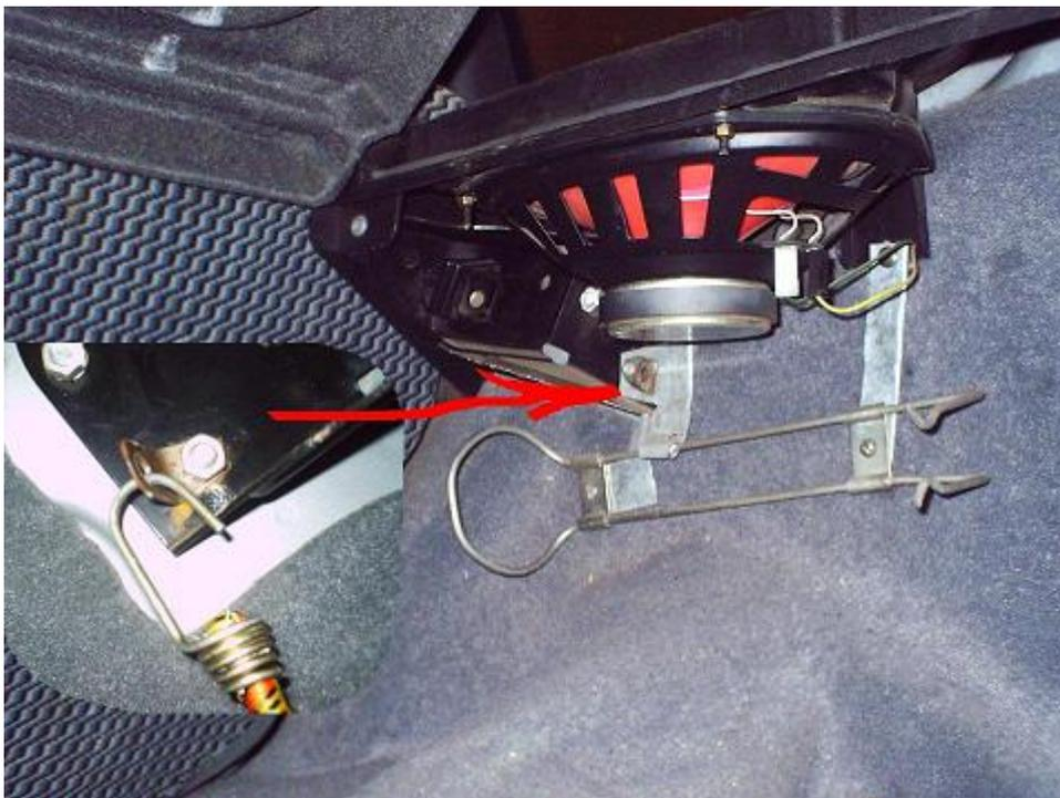
А) сверху приладил огнетушитель белорусского производства (на фото только его крепление) – марку уже не помню на двух кронштейнах из листового металла (я делал их из обычного оцинкованного кровельного железа, а народу рекомендую найти железо толщиной 1 – 1,5 мм).
