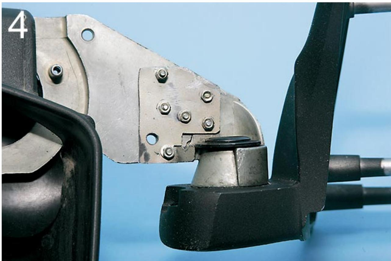
Рис. 3 и 4. Так выглядит с двух сторон место соединения обломков кронштейна с накладками. Чтобы в дальнейшем из-за вибраций не отвернуть винты и гайки, лучше зафиксировать их клеем, например, эпоксидным. Теперь необходимо аккуратно провести отремонтированную часть через «окно» пластмассового корпуса. Не забудем об ориентации, чтобы не получилось «задом наперед».
