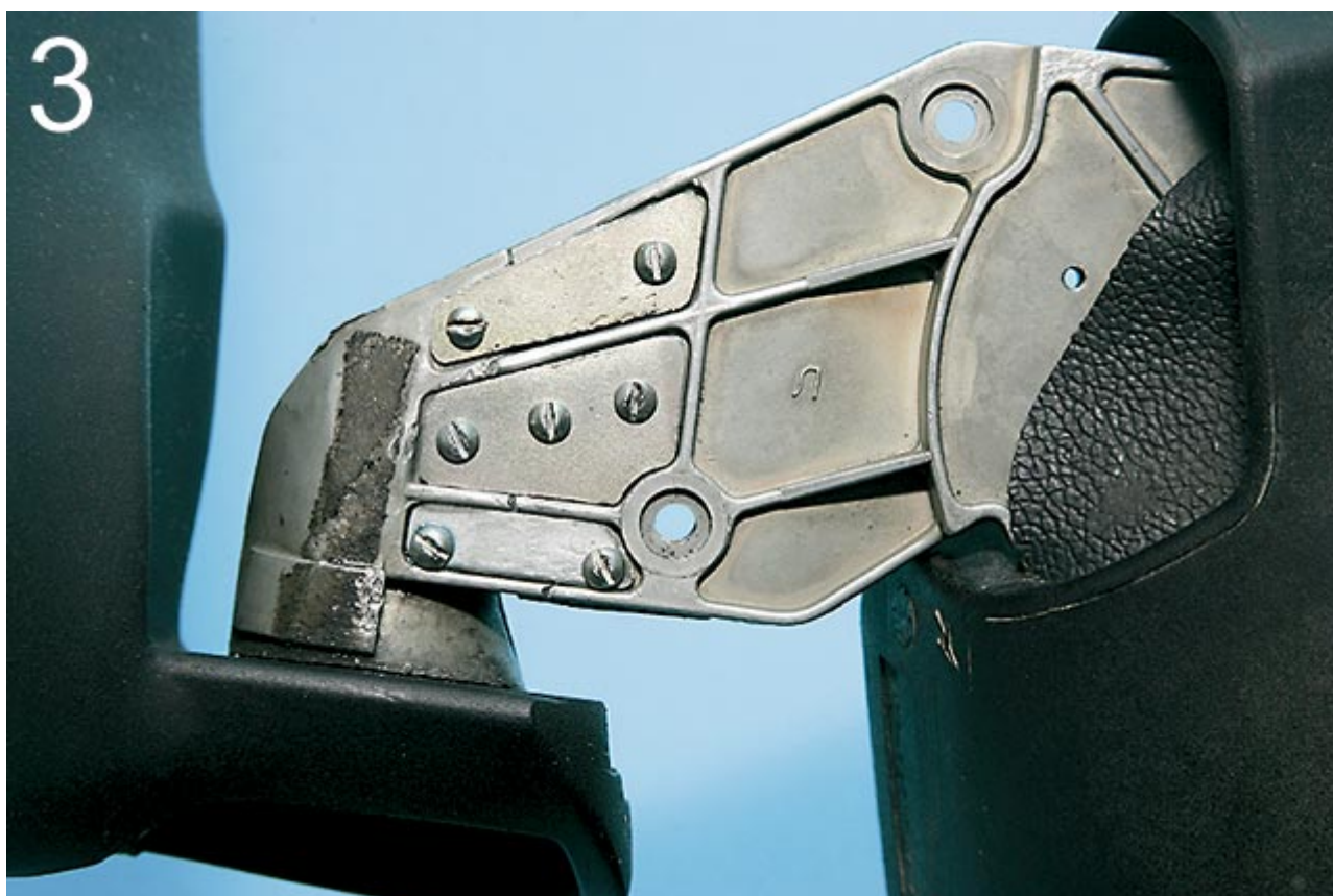
Рис. 2. Соединить две части кронштейна можно по-разному. Мы выбрали то, что доступней. Состыковав обломки, вырезали из картона шаблоны накладок, затем сделали их из листовой стали толщиной 1 мм. Собрали весь «пакет» и засверлили под винты М3. Результат вы видите: три накладки с одной стороны, а четвертая, большая, - с противоположной.
