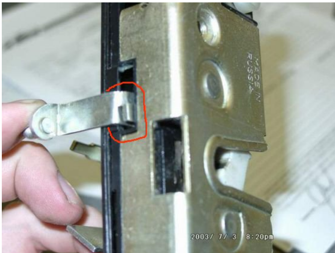
На третьей фотографии - замок с неисправностью.
