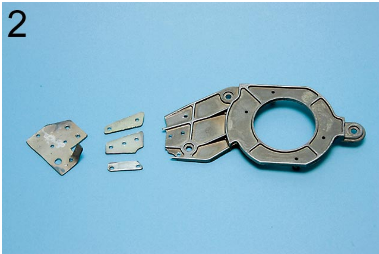
Рис. 2. Соединить две части кронштейна можно по-разному. Мы выбрали то, что доступней. Состыковав обломки, вырезали из картона шаблоны накладок, затем сделали их из листовой стали толщиной 1 мм. Собрали весь «пакет» и засверлили под винты М3. Результат вы видите: три накладки с одной стороны, а четвертая, большая, - с противоположной.
