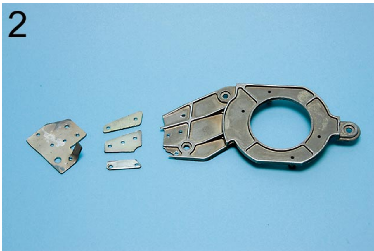
Рис. 1. Открутив и разобрав зеркало, увидели вот эти фрагменты. Здесь 0-0 - ось, вокруг которой, по задумке конструктора, оно должно складываться. Но когда мы попытались, оказалось, что коррозия сильнее! Если нажать покрепче - разлетится и то, что осталось. Мораль: владелец должен жить по флудским законам - едешь или нет, зеркало регулярно шевели, повертывай!
