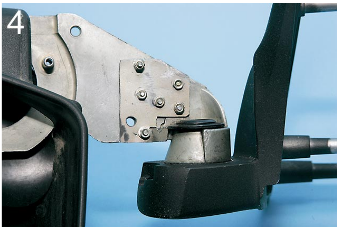
Рис. 3 и 4. Так выглядит с двух сторон место соединения обломков кронштейна с накладками.
