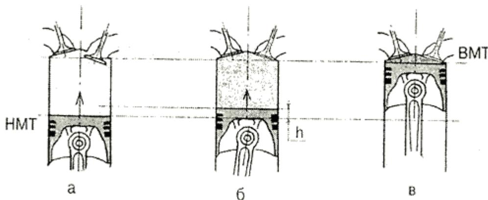
При движении поршня их нижней мертвой точки (а) давление начинает повышаться только после закрытия впускного клапана (б) и достигает максимума в верхней мертвой точке (в):  $h$  - перемещение поршня, при котором давление в цилиндре не повышается
